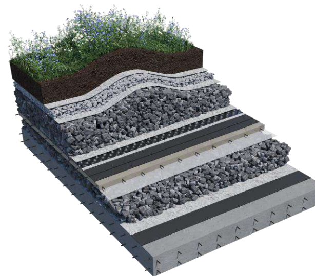
УТЕПЛЕНИЕ ЭКСПЛУАТИРУЕМЫХ КРОВЕЛЬ (зеленые кровли)
